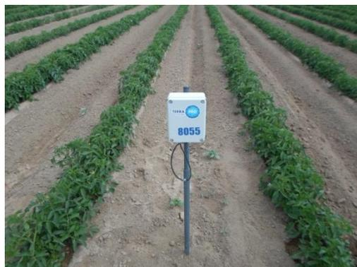
**Figura 10** – Estação de monitorização da humidade do solo.
